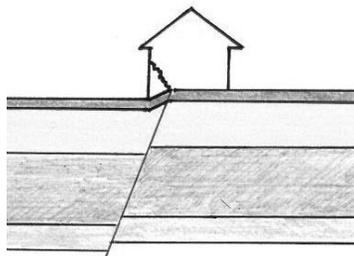
Die Darstellung zeigt Gebäuderisse aufgrund von Bodensenkungen, wie sie bei Flutungen von Kalibergwerken entstehen können.
